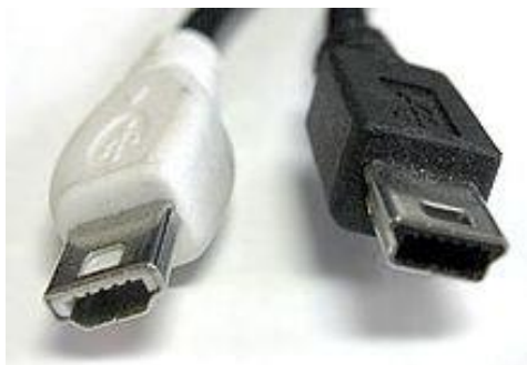
图 3-3 Mini 接口（左：A 型，：右 B 型）
