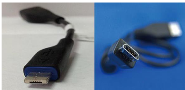
图 3-4 Micro USB 接口（左：A 型，右：B 型）
