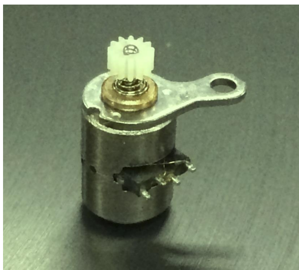
图 8 Ver2 电机控制模块使用的步进电机
